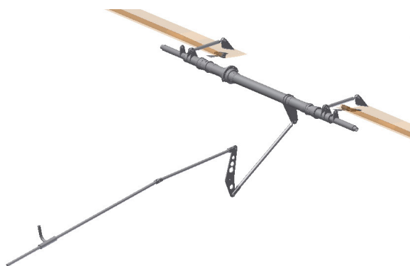
2 pav. Užsparnių mechaninė valdymo sistema sumodeliuota Autodesk Inventor Professional 2011 programa
