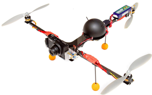
5 pav. Trisraigtis sraigtasparnis Fig. 5. Tricopter
