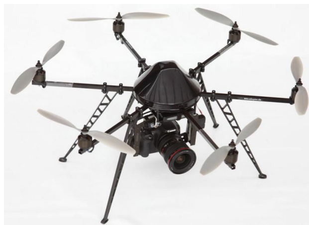
7 pav. Šešiasraigtis sraigtasparnis Fig. 7. Hexacopter
