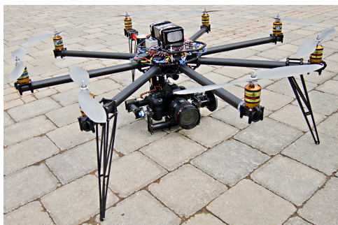
8 pav. Aštuonsraigčio sraigtasparnis Fig. 8. Octocopter
