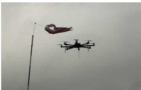
11 pav. Aštuonsraigčio sraigtasparnio bandymas esant skirtingam vėjo greičiui
