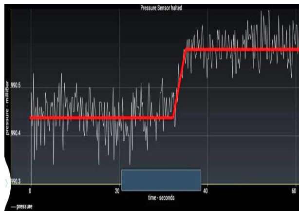
20 pav. Aukščio pokyčio fiksavimas nuleidus išmanųjį telefoną 1 metrą žemyn
