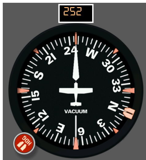
16 pav. Aircraft Compass free programa, naudojanti išmaniojo telefono magnetinio lauko duomenis, veikia kaip orlaivio girokompaso prietaisas
