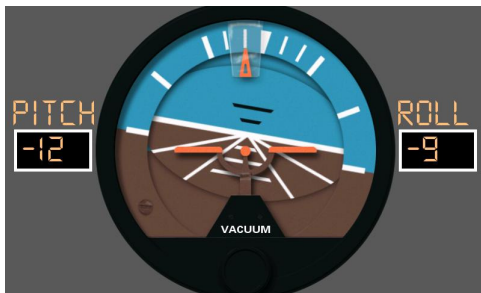
10 pav. Aircraft Horizon free , naudojanti išmaniojo telefono giroskopo duomenis, programa veikia kaip orlaivio aviahorizonto prietaisas
